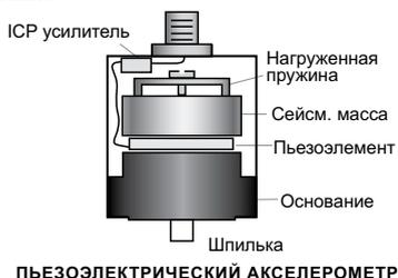
чувствительности вибропреобразователя указаны на маркировке на корпусе датчика. При установке на объект трехкомпонентный датчик нужно ориентировать так, чтобы направления осей чувствительности **X, Y, Z** совпадали с интересующими направлениями вибрации.
