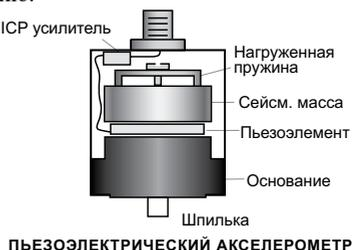
При установке на объект трехкомпонентный датчик нужно ориентировать так, чтобы направления осей чувствительности **X, Y, Z** совпадали с интересующими направлениями вибрации.
